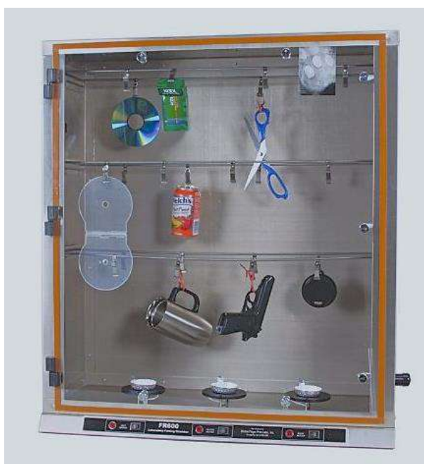
Slika 2.32. Komora za cijanoakrilatno zaparivanje
