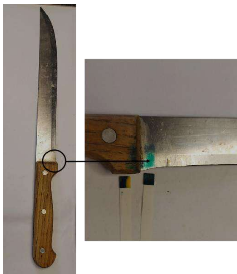
Slika 2.8. Ostatak krvi na nožu nakon pranja noža. Na slici desno prikazano je pozitivno obojenje kojim se dokazuje prisustvo krvi
