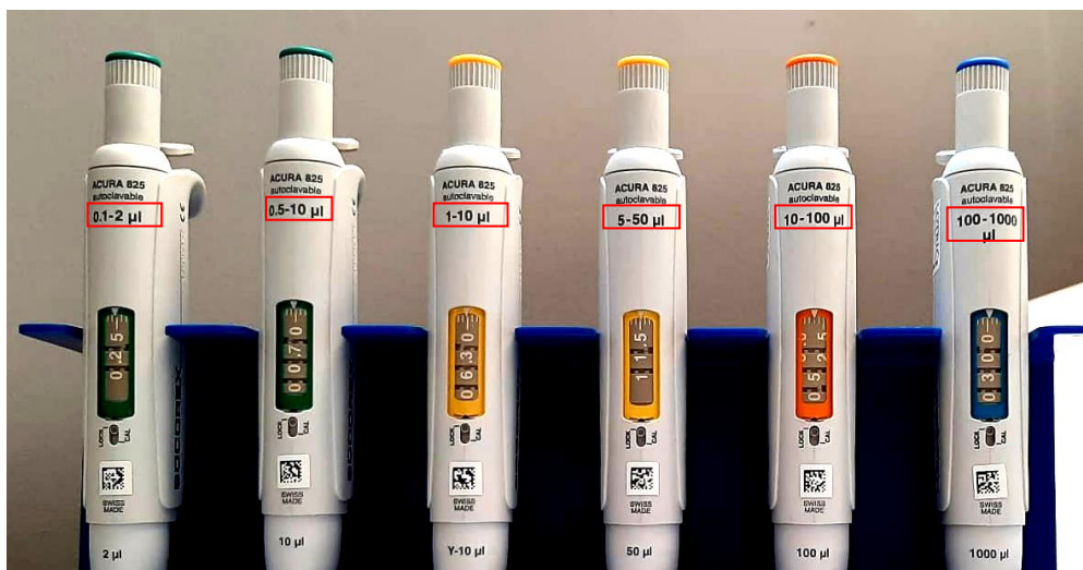
Slika 27. Pipete s obilježenim različitim rasponom volumena. Okretanjem klipa dolazi do promjene volumena
